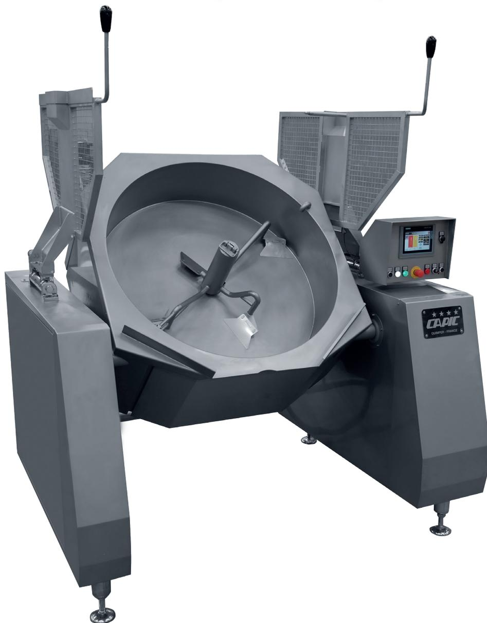
**La hauteur de cuve est de 295 mm pour respecter la qualité et la coloration du produit.**
