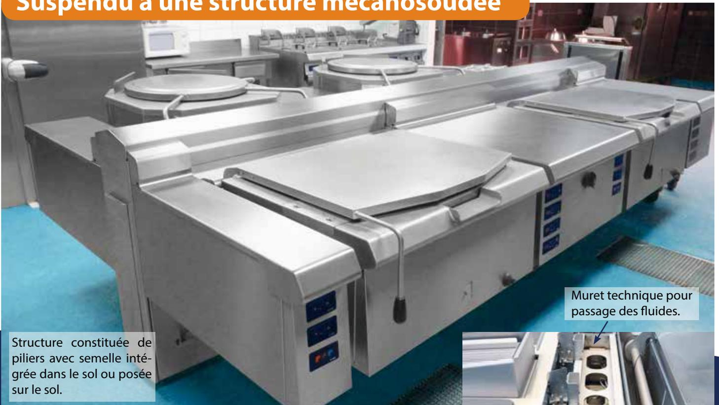
Structure constituée de piliers avec semelle intégrée dans le sol ou posée sur le sol.
