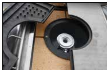
Plaque en fonte spéciale munie de picots et de briques réfractaires
