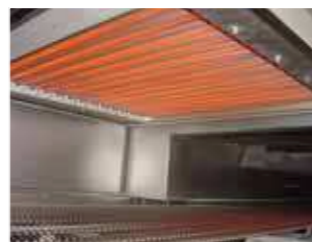
Rayonnement sur 1 face Heating on one surface
