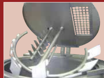
Bras racleur incliné amovible et satellite entraîné. Inclined, removable scraper arm and satellite mixer.
