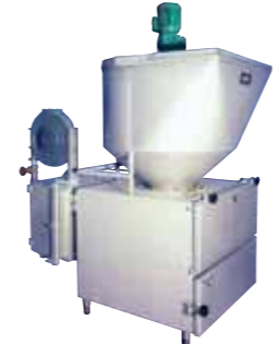
Générateur à sciures de bois. Sawdust smoke generator.
