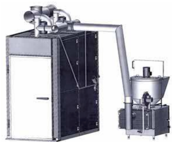
Exemple : implantation générateur de fumée à sciure
