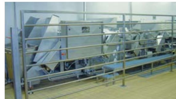
Cuiseur-refroidisseur 500 ou 1000 litres pour l'industrie.
